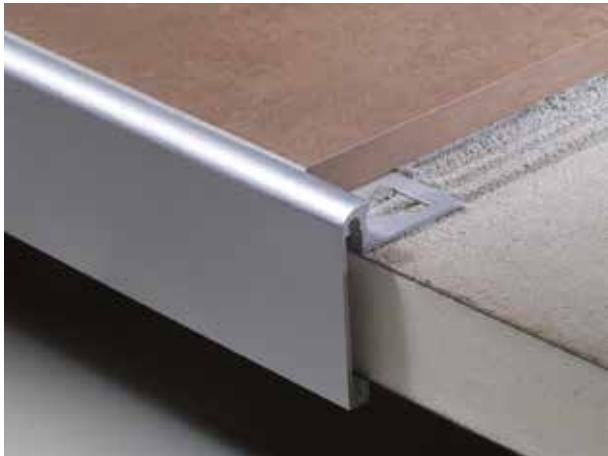
Profilo idoneo come raccordo tecnico per piani cucina piastrellati. Il profilo presenta una parte sagomata per raccordare lo spigolo del piano cucina e una parte a scendere che ricopre lo spessore del medesimo con elevate funzioni tecniche ed estetiche. Planotec BP è un profilo estruso in alluminio anodizzato argento dotato di raccordo in alluminio per angoli esterni.
